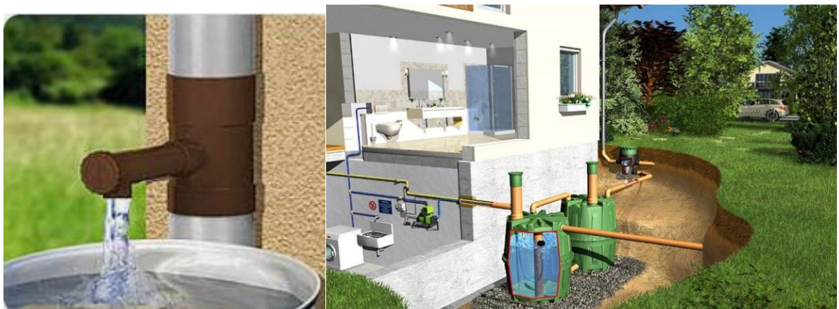
Рис. 3.3. Збір дощової води для поливу з даху приватного будинку
