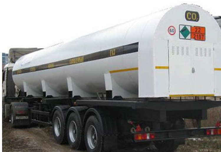
Рисунок 11 – Автомобільна цистерна для перевезення CO 2 [3]
