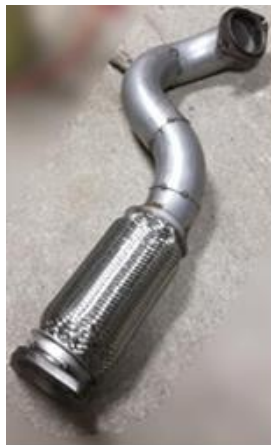
Рисунок 24 - Виготовлена з'єднувальна труба вихлопної системи
