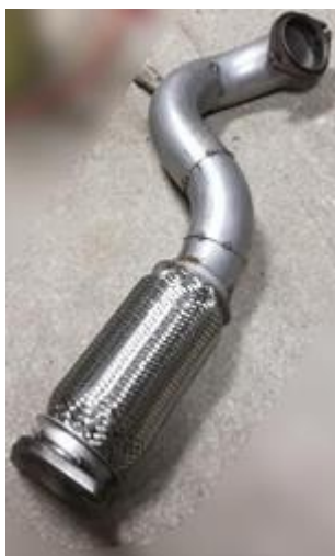
Рисунок 3.11 - Виготовлена з'єднувальна труба вихлопної системи
