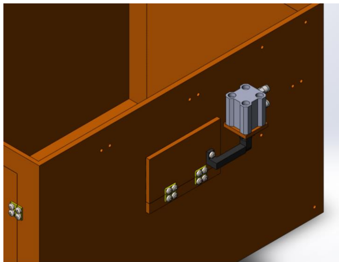
Рисунок 3.39 – Кріплення пневмоциліндру кришки вентиляції
