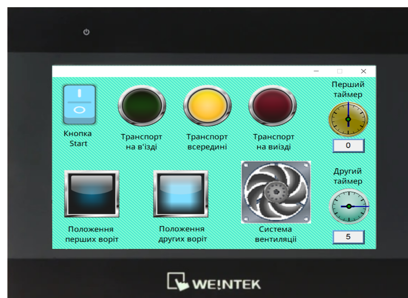
Рисунок 3 – Робота сенсорної панелі коли транспортом знаходиться всередині
