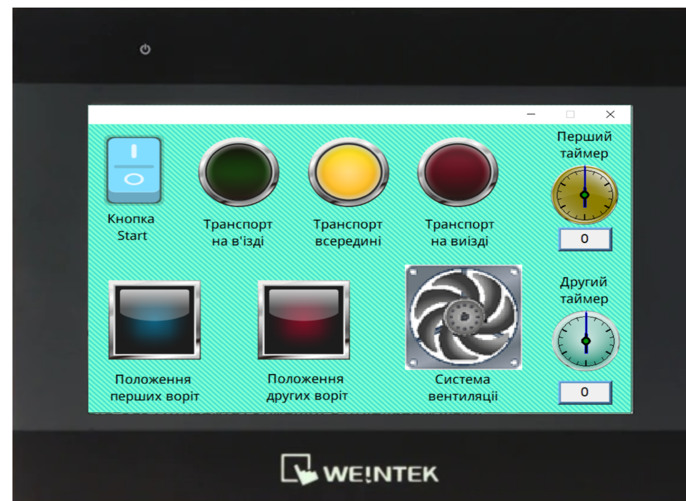
Рисунок 3 – Робота сенсорної панелі коли транспортом знаходиться всередині
