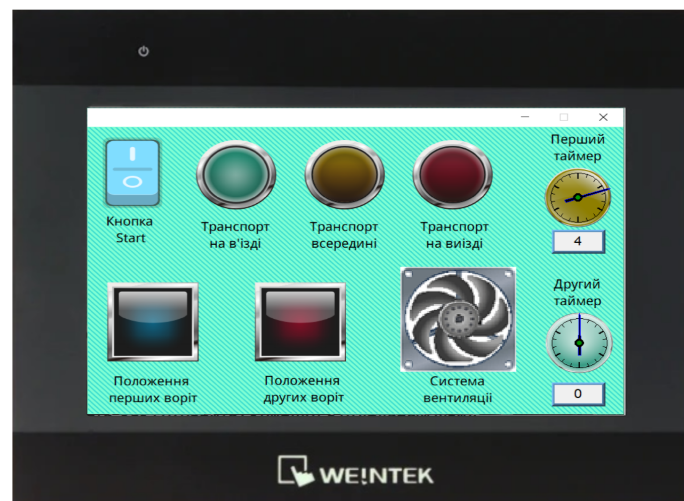
Рисунок 1 – Робота сенсорної панелі коли транспортом перед в'їздом
