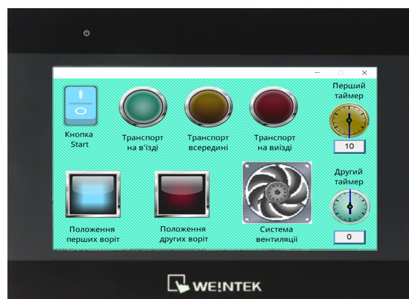
Рисунок 2 – Робота сенсорної панелі при в'їзді транспорту в шлюз
