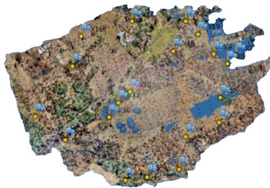
Рисунок 4. Розташування камери та накладання зображень.
