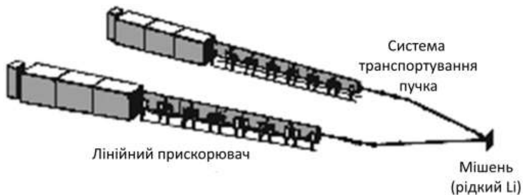
Рисунок 1.5 – Спрощена схема установки IFMIF [4].
