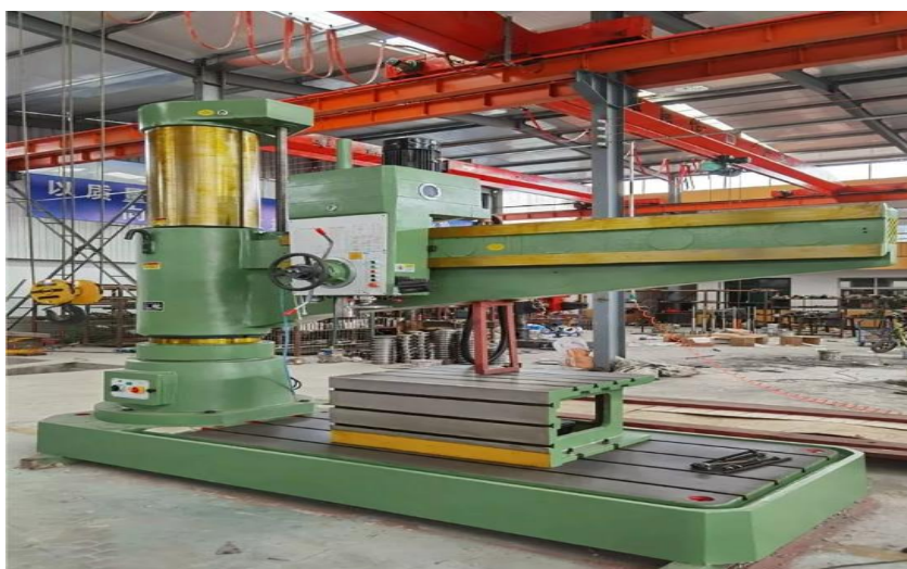
Рисунок 2.11 – Радіально-свердлильний верстат ZJ Radial Drilling Machine [26]
