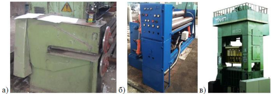
Рисунок 2.10 – Устаткування для виконання заготівельних операцій: дискові ножиці (а), вальцювальна машина (б) та гідравлічний прес (в)
