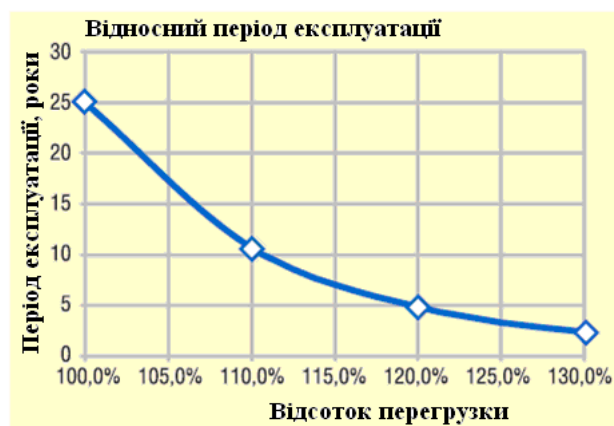
Рисунок 1.16 - Вплив перевантаження на період експлуатації редуктора
