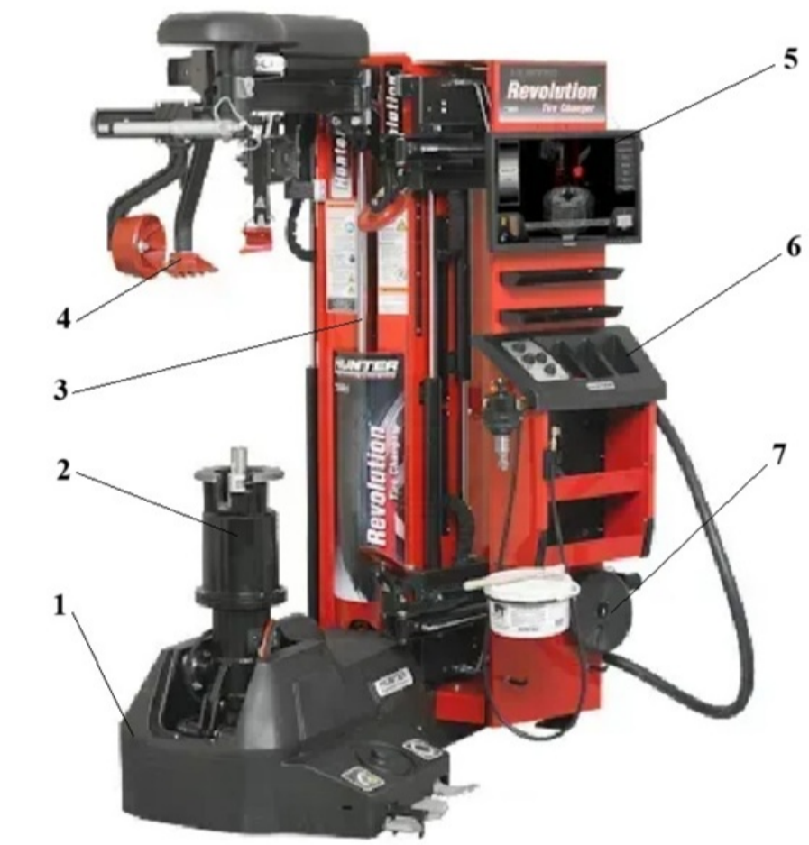
1 – основа стану; 2 – зажим для коліс; 3 – гідроциліндр; 4 – монтажні лопатки; 5 – ЛСД дисплей керування та індикації; 6 – відділення для деталей; 7 – віджим для коліс
