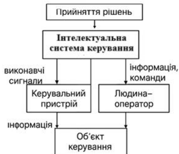
Рис. 2.2. Узагальнена архітектура ІСК технологічним процесом
