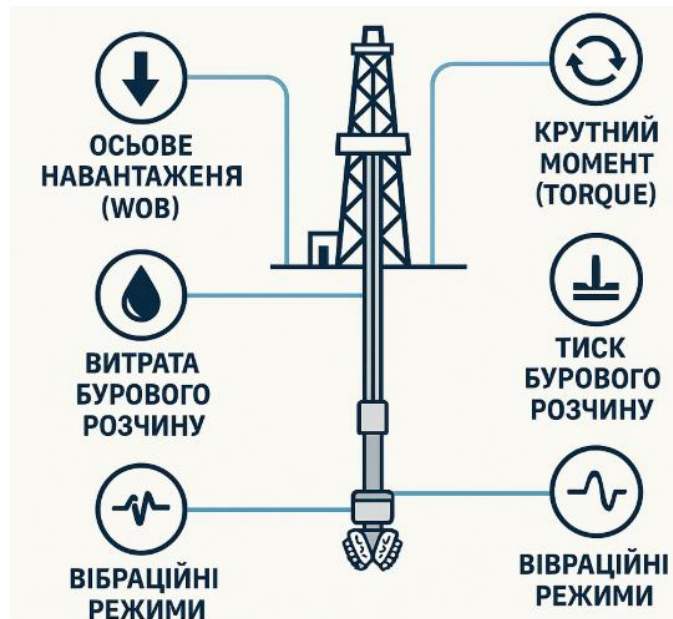
Рис.1.2.Схема технологічних параметрів контролю та керування
