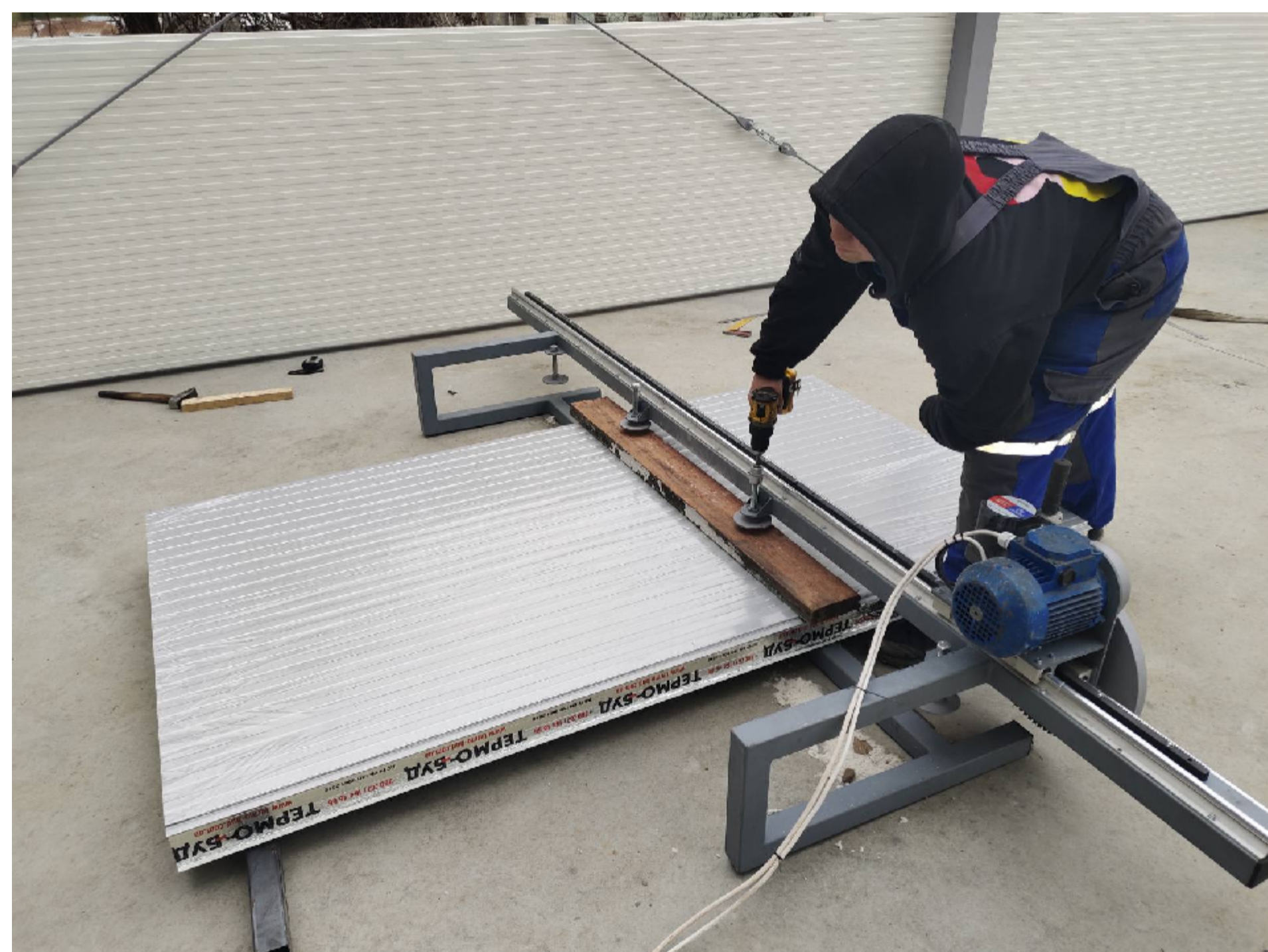
Позиціонування та затиск сендвіч-панелів в пристрої
