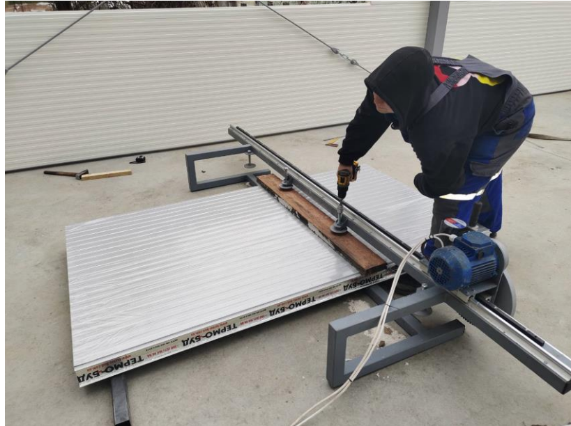
Рис 6.5 – Позиціонування та затиск сендвіч-панелів в пристрої
