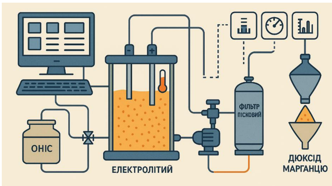
Рисунок 4.1 – Система керування процесом виробництва електролітичного діоксиду марганцю
