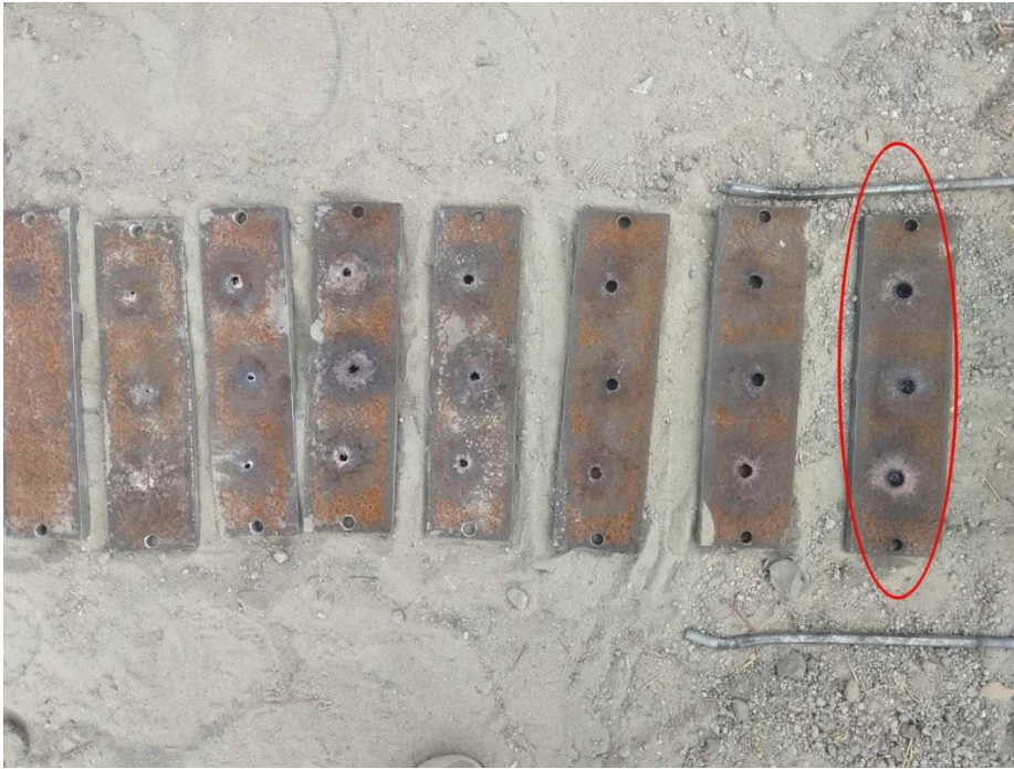
Фото 1. Результати контрольних випробувань кумулятивного заряду в сталій мішені довжиною 250 мм, товщиною 10 мм
