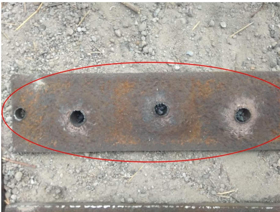
Фото 2. Результати контрольних випробувань кумулятивного заряду в сталій мішені товщиною 10 мм (елемент випробувального пакету)
