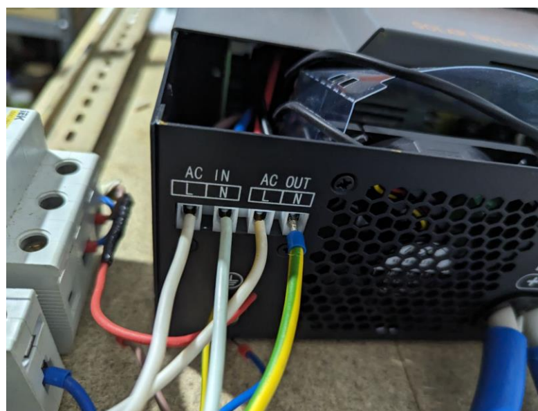
Рисунок 2.5 – Підключення до інвертора вхідної і вихідної ліній
