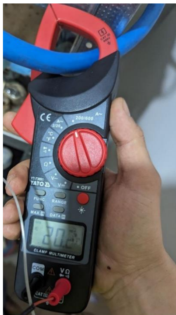
Рисунок 3.10 – Струм навантаження від АКБ до інвертора
