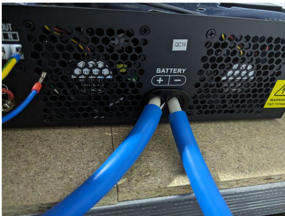
Рисунок 2.3 – Підключення акумуляторів до інвертора
