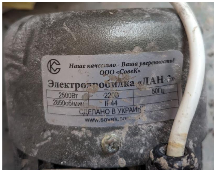
Рисунок 3.11 – Зображено характеристики асинхронного двигуна
