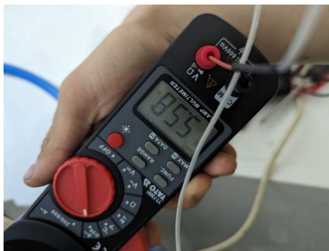
Рисунок 3.8 – Струм навантаження 1300 Вт
