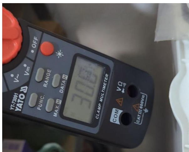
Рисунок 3.16 – Струм при пуску двигуна 2500Вт
