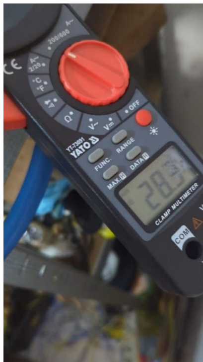
Рисунок 3.14 – Струм при пуску двигуна
