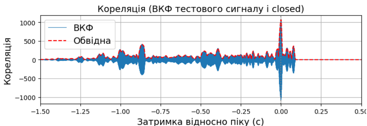
Рисунок 2.4 – Зареєстрований сигнал (а) та ВКФ тестового сигналу та зареєстрованого при відсутності витоку (стан трубопроводу «закрито»)
