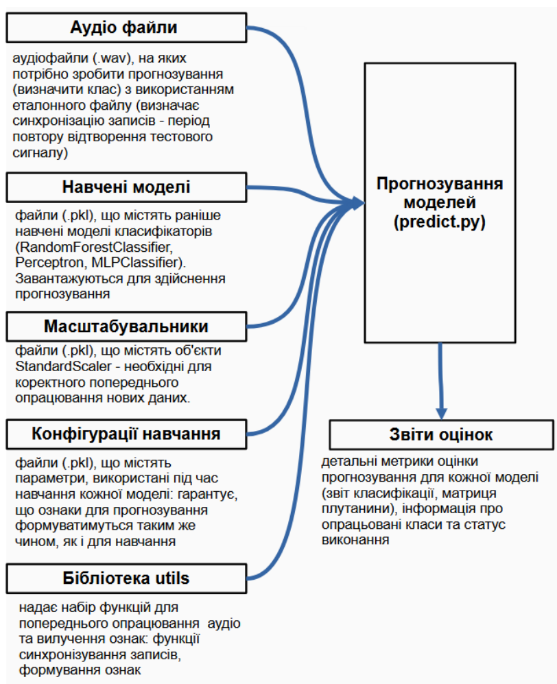
Рисунок 3.1 – Функціональна схема інформаційних потоків модуля прогнозування
