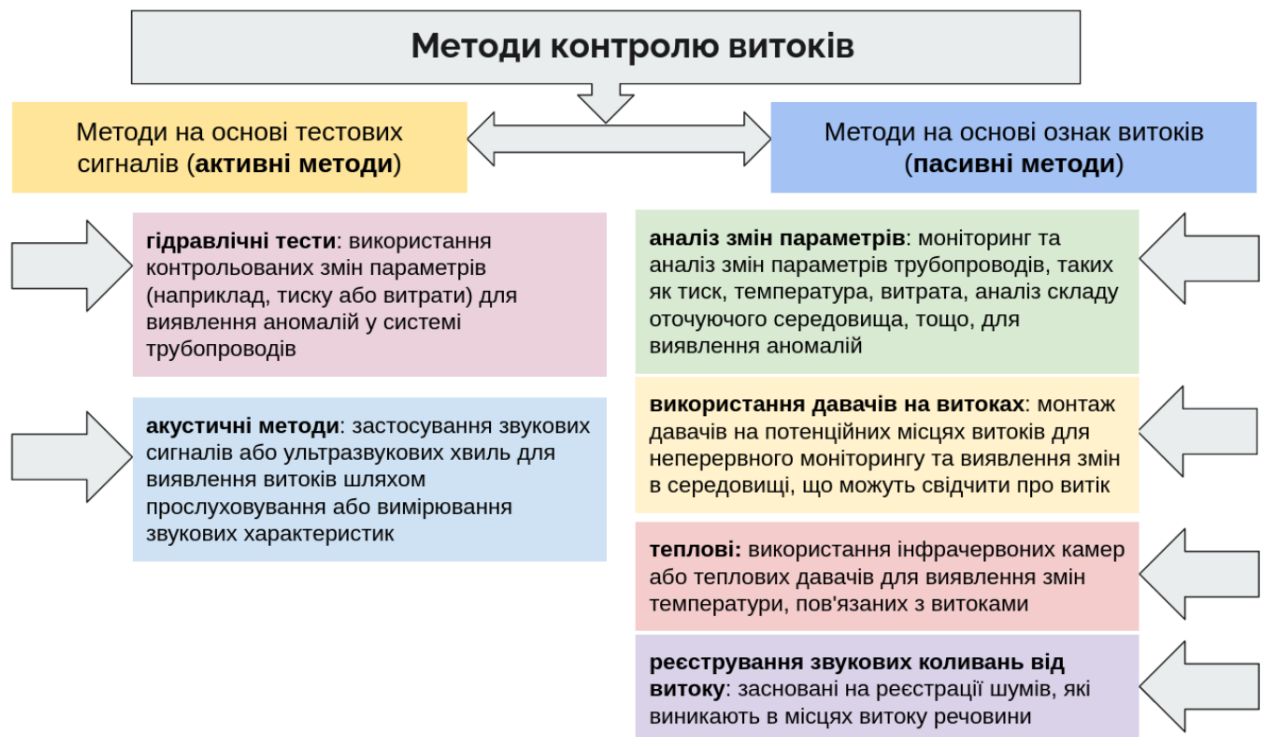
Рисунок 1.1 – Методи контролю/детектування витоків
