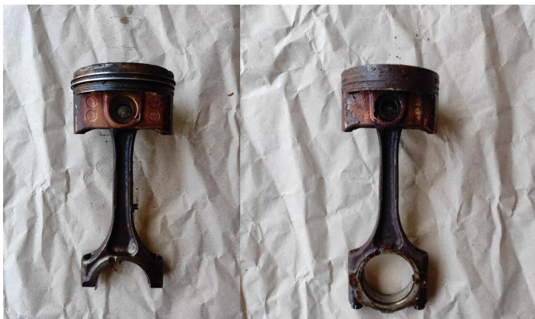
Рисунок 7.4 — неочищені поршні із шатунами двигуна після демонтування: зліва поршень 4-го циліндра; справа — поршень 1-го циліндра
