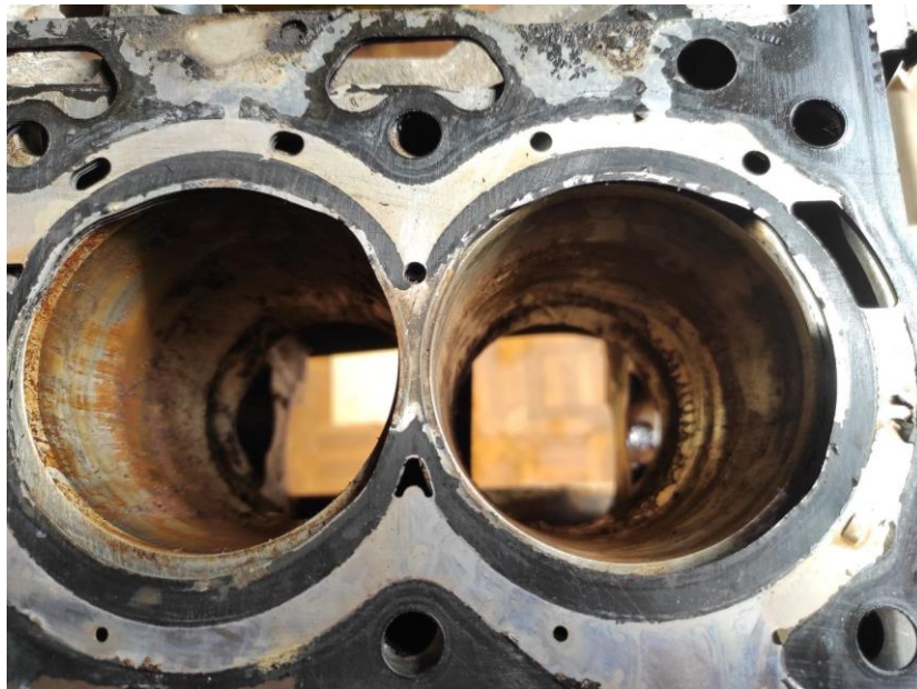
Рисунок 7.2 — місце пробою прокладки ГБЦ на двигуні
