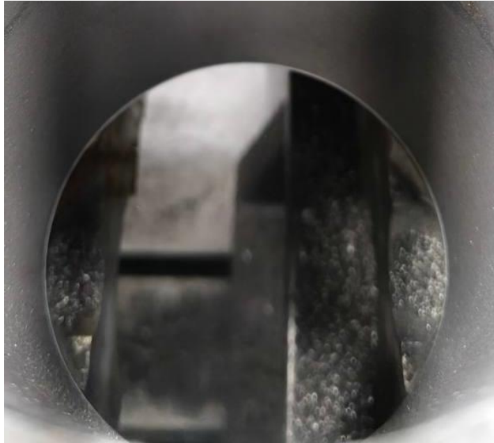
Рисунок 7.5 — упорний буртик після розточування циліндра
