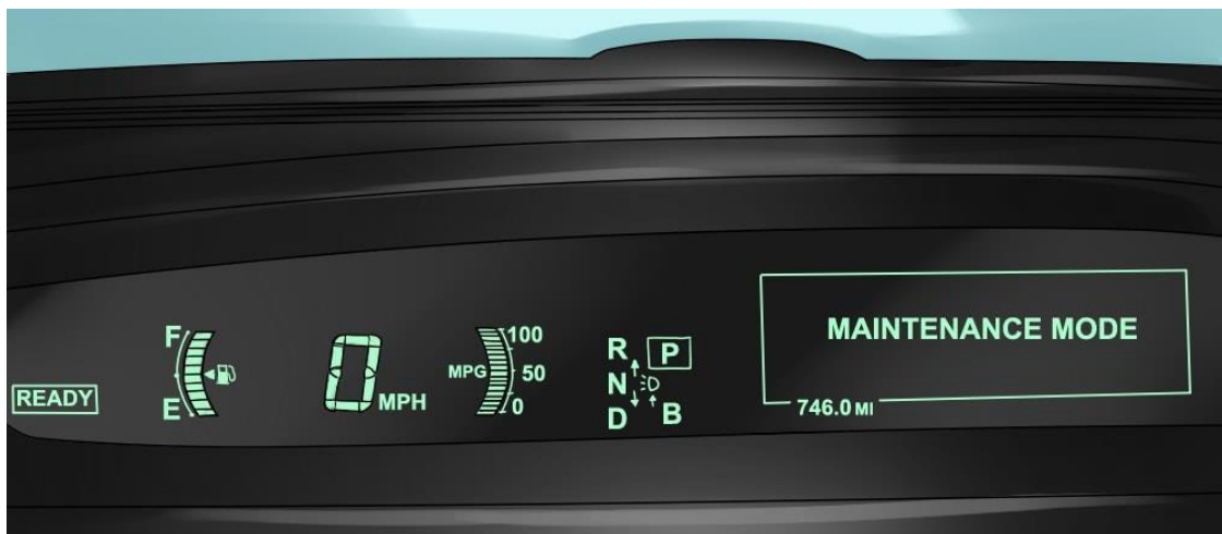
Рисунок 6.2 — панель приладів із індикацією "Maintenance Mode"
