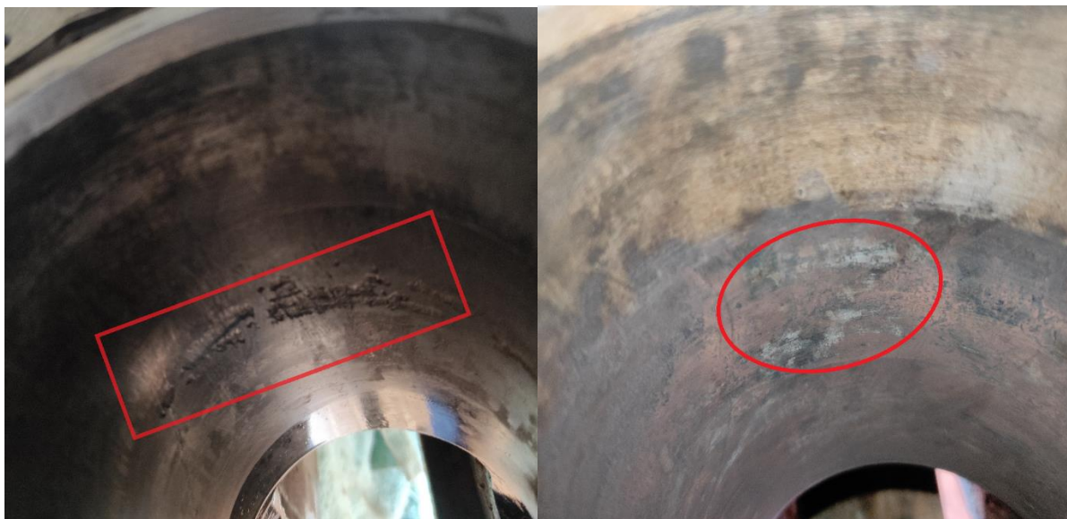
Рисунок 7.3 — корозійні пошкодження на дзеркалі 1 та 2 циліндрів
