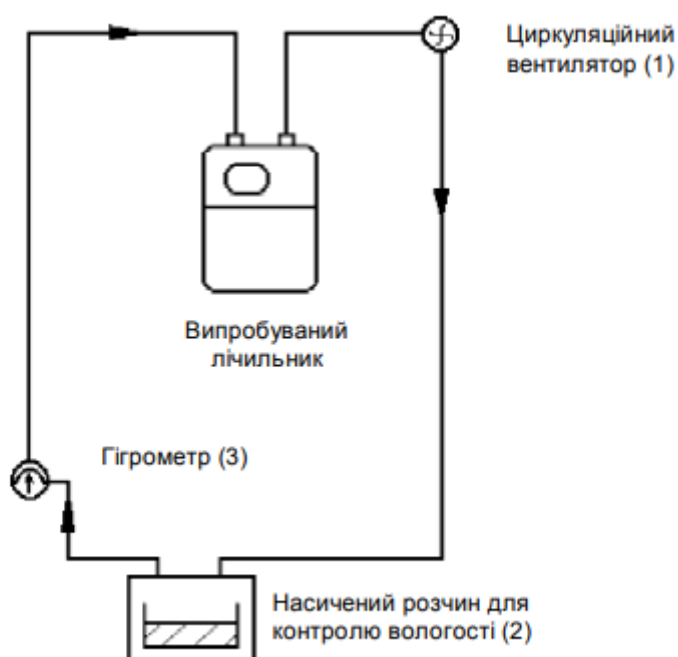
Рисунок 1.2 — Схема обладнання для випробування водяною парою
