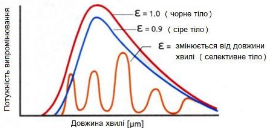
Рисунок 1.4 – Порівняння спектральних властивостей випромінювання чорного, сірого та селективного тіл
