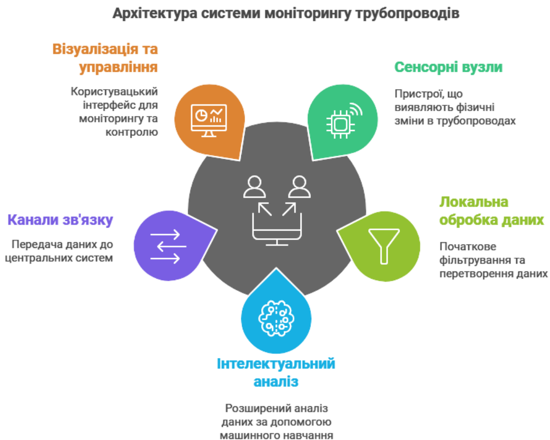
Рисунок 3.1 – Загальна структура архітектури системи моніторингу герметичності.
