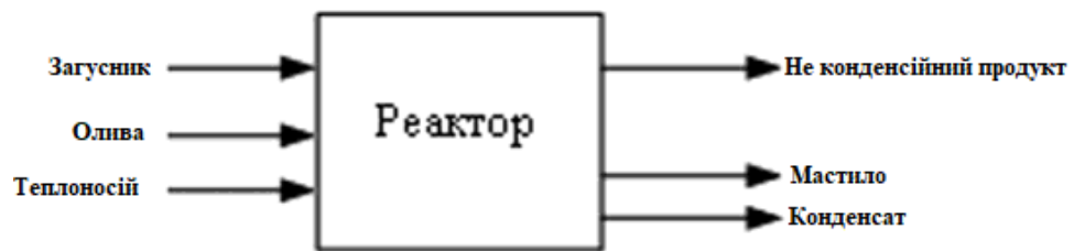
Рис. 3.2. Схема вихідних та вхідних потоків реактора
