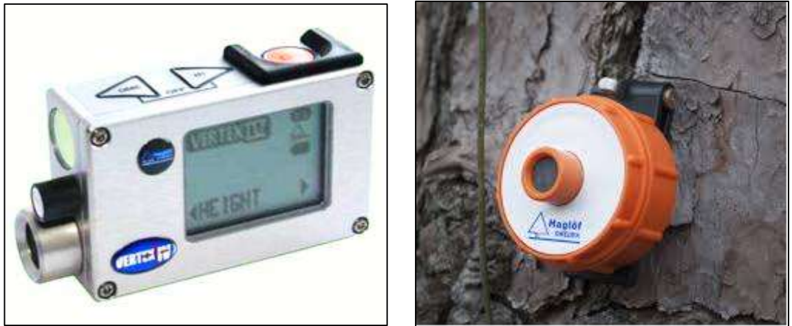
Рисунок 3.7 – Висотомір ультразвуковий тригонометричного принципу дії «Vertex IV» (Швеція) з транспондером [34]
