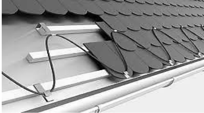
Рис. 5.16. Загальний вигляд системи електрокабельного резисторного сніготанення
