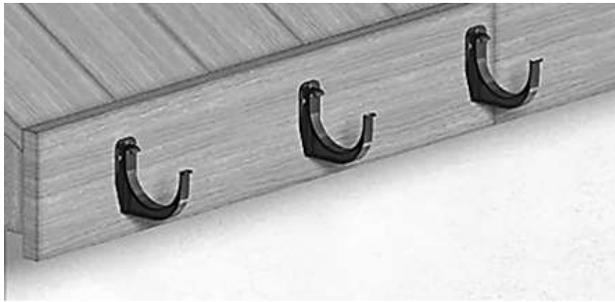
Рис. 5.7. Схема встановлення кронштейнів ринви (гаків)
