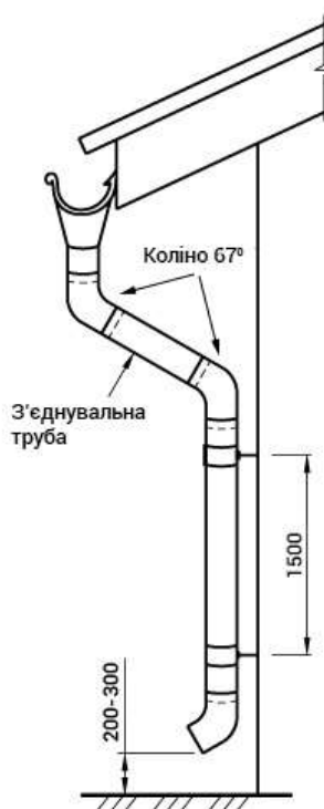
Рис. 5.9. Визначена довжини вставки водостічної труби «Лебедина шия»
