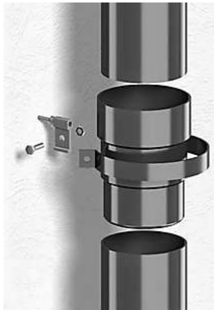
Рис.5.10 Схема з'єднання водостічних труб муфтою
