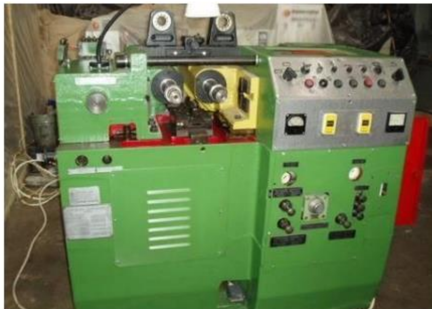
Рисунок 2.3 - Профіленакатний двороликовий напівавтомат А9518Б
