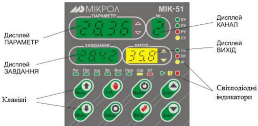
Рисунок 4.1 - Вигляд передньої панелі контролера
