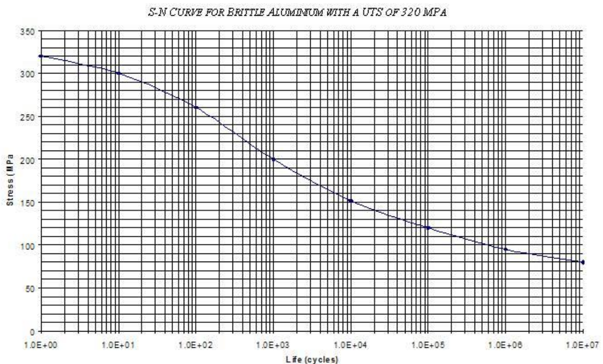
Рис 1.4 Крива Веллера. Горизонтальна вісь — число циклів (N), вертикальна — максимальне напруження циклу ( \sigma_{\text{max}} ) [5]
