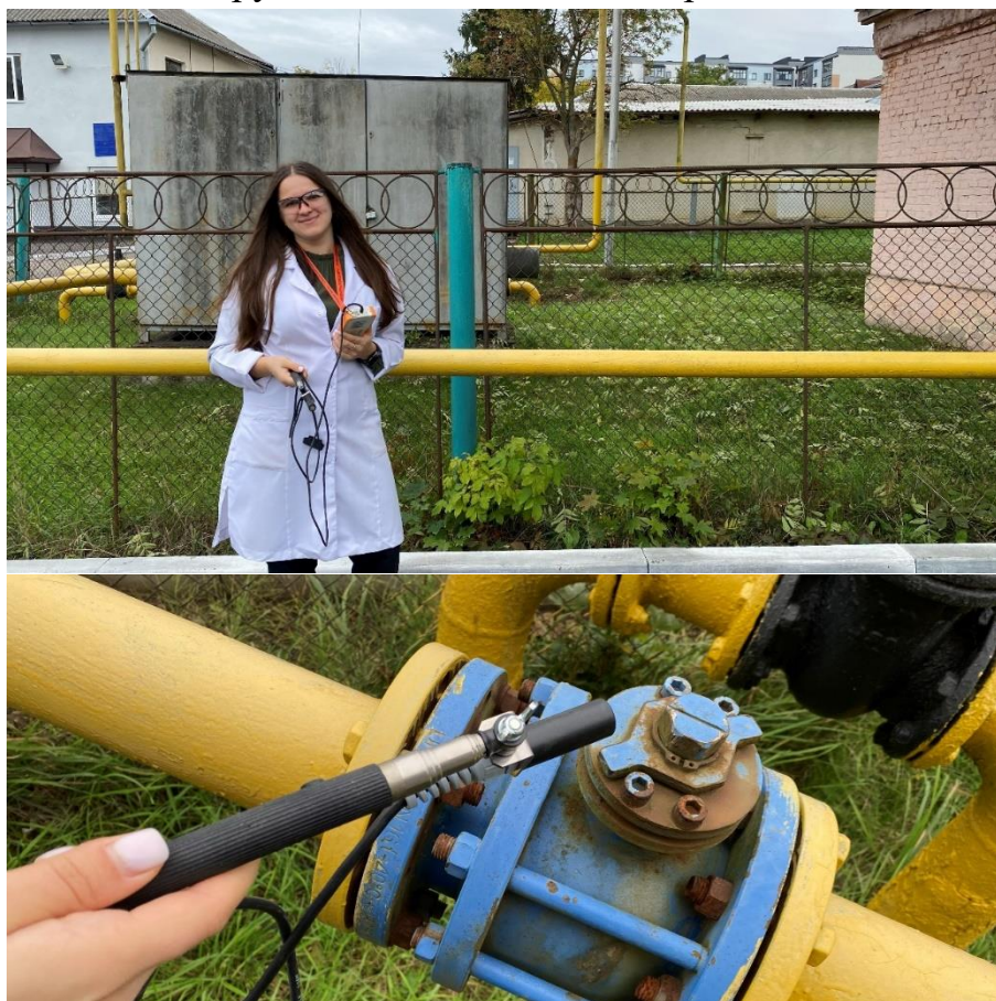
Рис. 4.1 Виявлення витоків метану на території ІФНТУНГ
