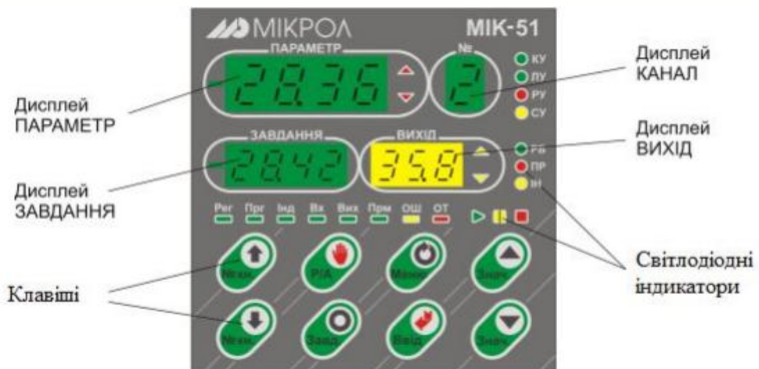
Рисунок 5.1 - Елементи оперативного управління мікропроцесорного контролера
