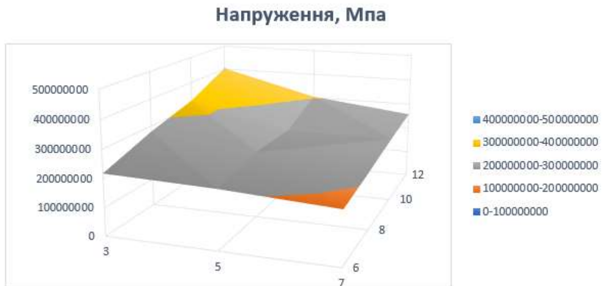
Рисунок 5.16 – Залежність еквівалентних напружень від s і t
