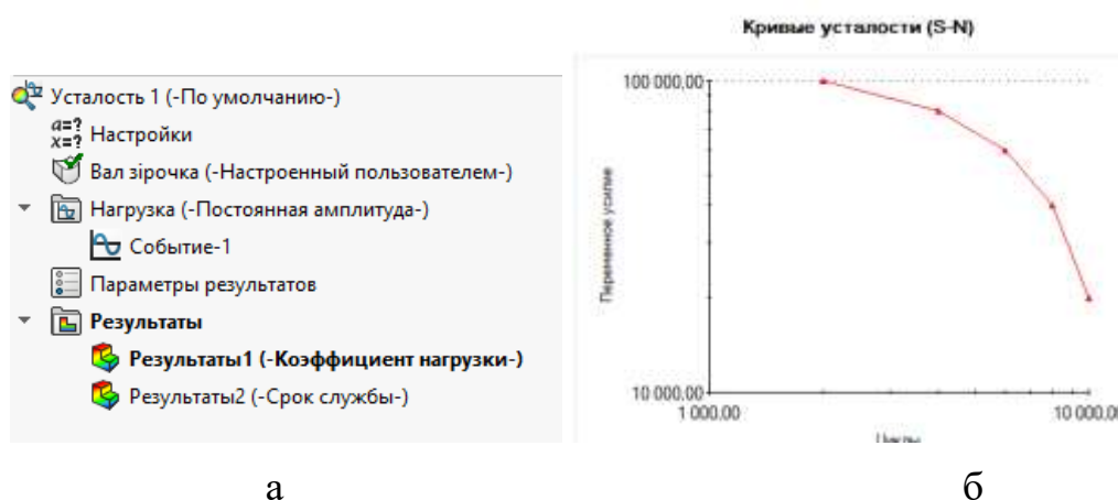
Рисунок 5.1.4 – Вхідні дані і результати (а) та крива втоми для сталі 45 для R=0 (б)
