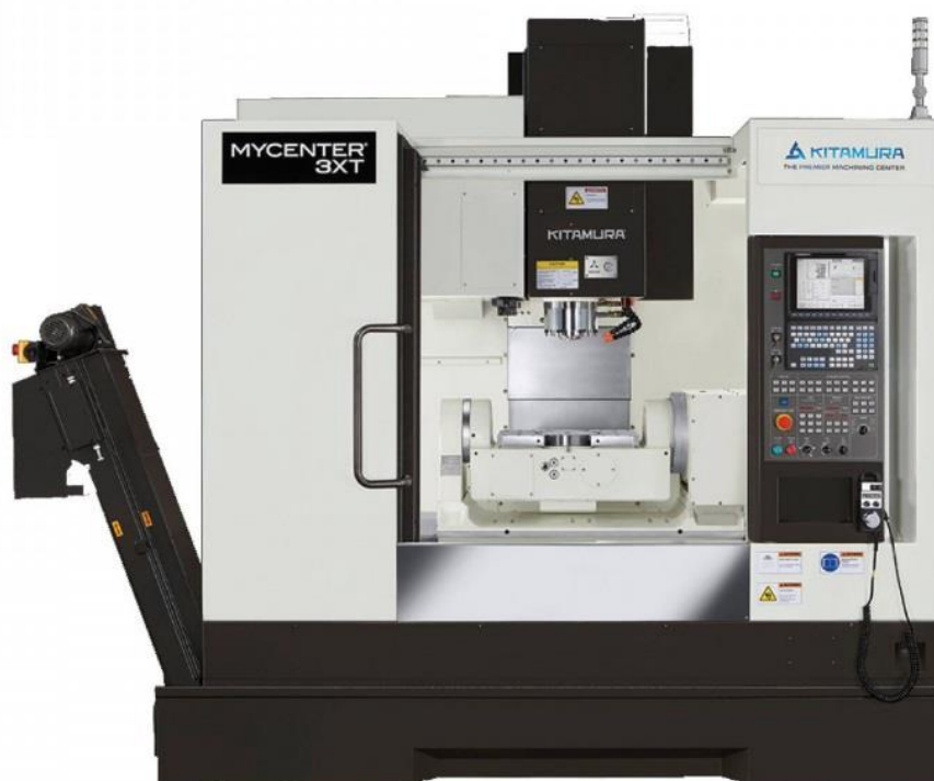
Рис.1.8 – Зовнішній вигляд п'ятикоординатного оброблюючого центра KITAMURA MYCENTER 3XT
