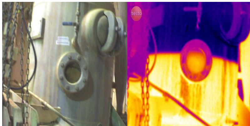
Рисунок 1.33 – Визначення рівня рідини в ємкості
