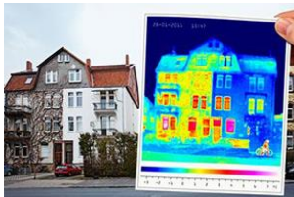
Рисунок 2.1 - Теплоаудит утепленого будинку. Порівняння термограмми та цифрового фото
