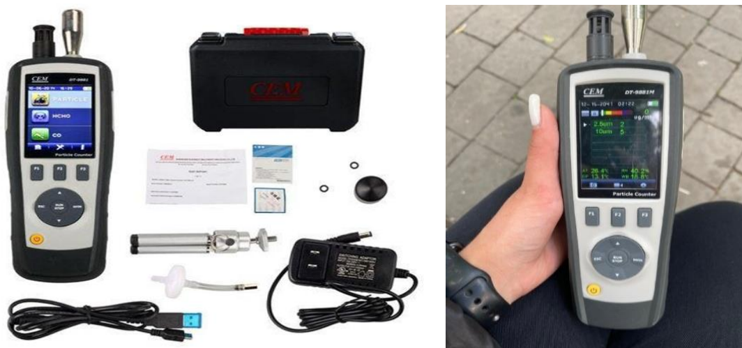
Рисунок 2.1 – Складові CEM DT-9881 та прилад в процесі дослідження
