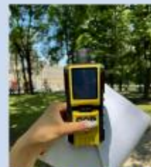
Рисунок 4 - Газовий детектор Walcom W-K-600, яким виміряли концентрації вуглецю оксиду CO та діоксиду азоту NO2
