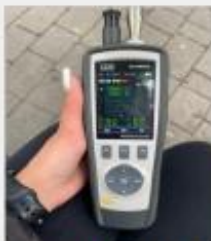
Рисунок 3 - Аналізатор якості повітря SEM DT-9881, яким виміряли концентрації ТЧ2,5, ТЧ10, формальдегіду
