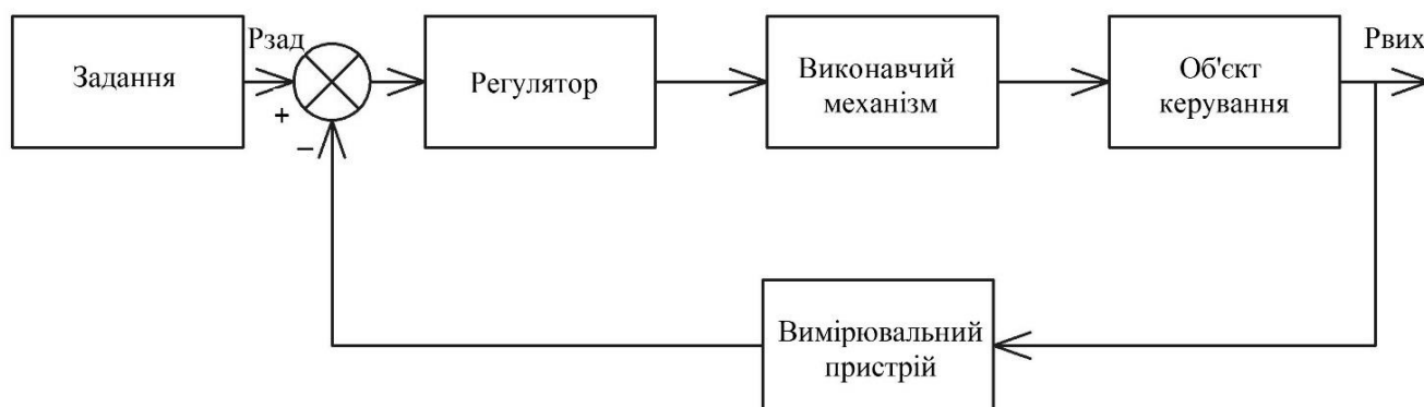
Рис. 4.1. Структурна схема АСК
