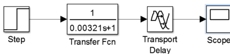
Рис. 3.1. Модель об'єкта керування в SIMULINK
