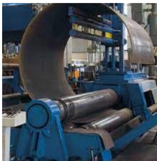
Рисунок 2.4 - Схема процесу вальцювання обичайки резервуару
