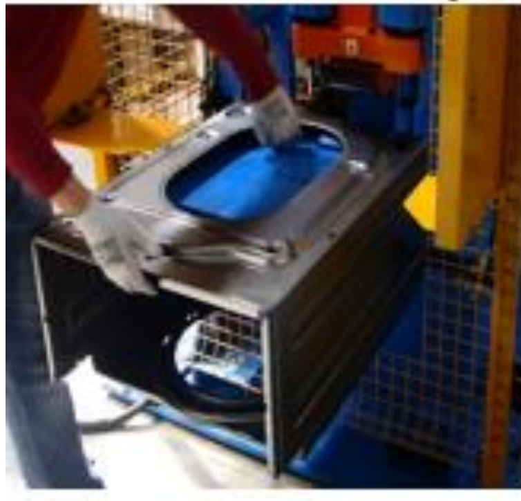
Рисунок 3.5 – Поточний процес з виготовлення додаткових отворів
