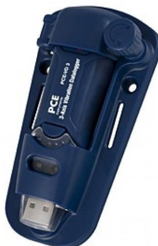
Рисунок 1.3 – Вигляд реєстратора вібрацій PCE-VD3
