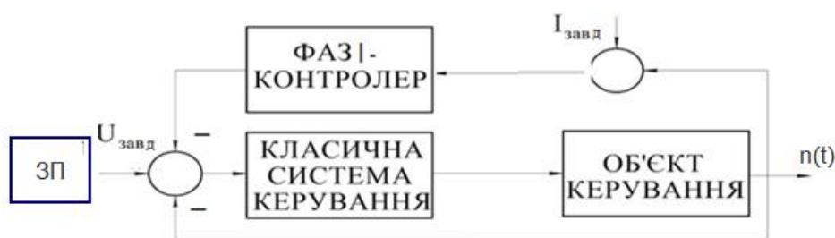
Рисунок 4.11 – Контур регулювання з фазі-корекцією у зворотному коригуючому зв'язку
