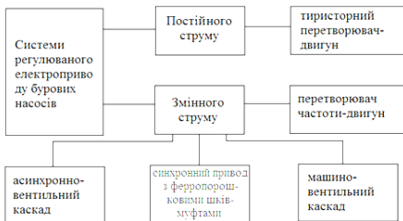
Рисунок 1.3 – Класифікація систем регулювання електроприводу бурових насосів [6]
