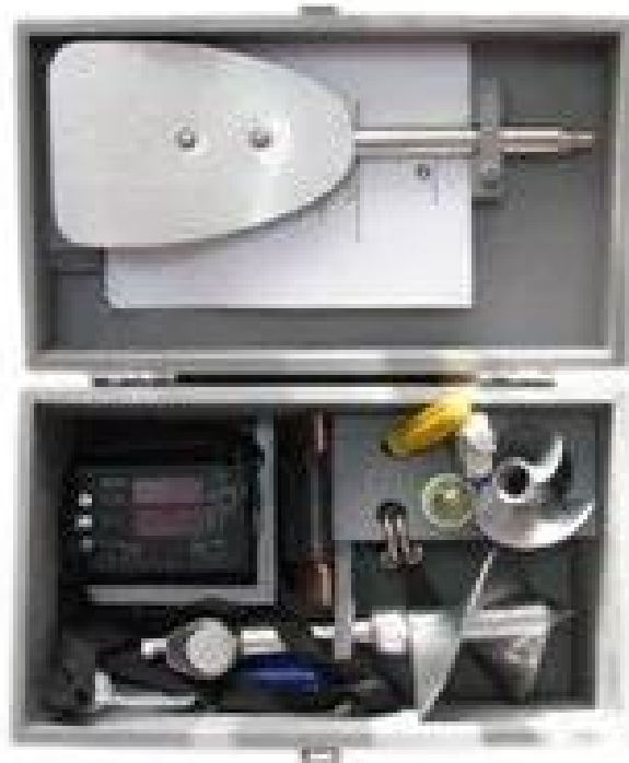
Рисунок 2.2 - Гідрометричний млинок типу ГР-21М [23]
