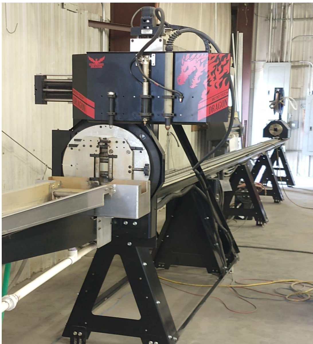
Рисунок 2.1 - Верстат для обробки труб Bend-Tech Dragon A400
