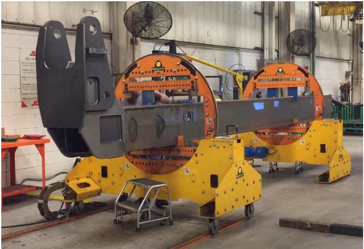
Рисунок 2.4 – Верстат для обробки металу RIMKO Rotator “Barramundi” RA
