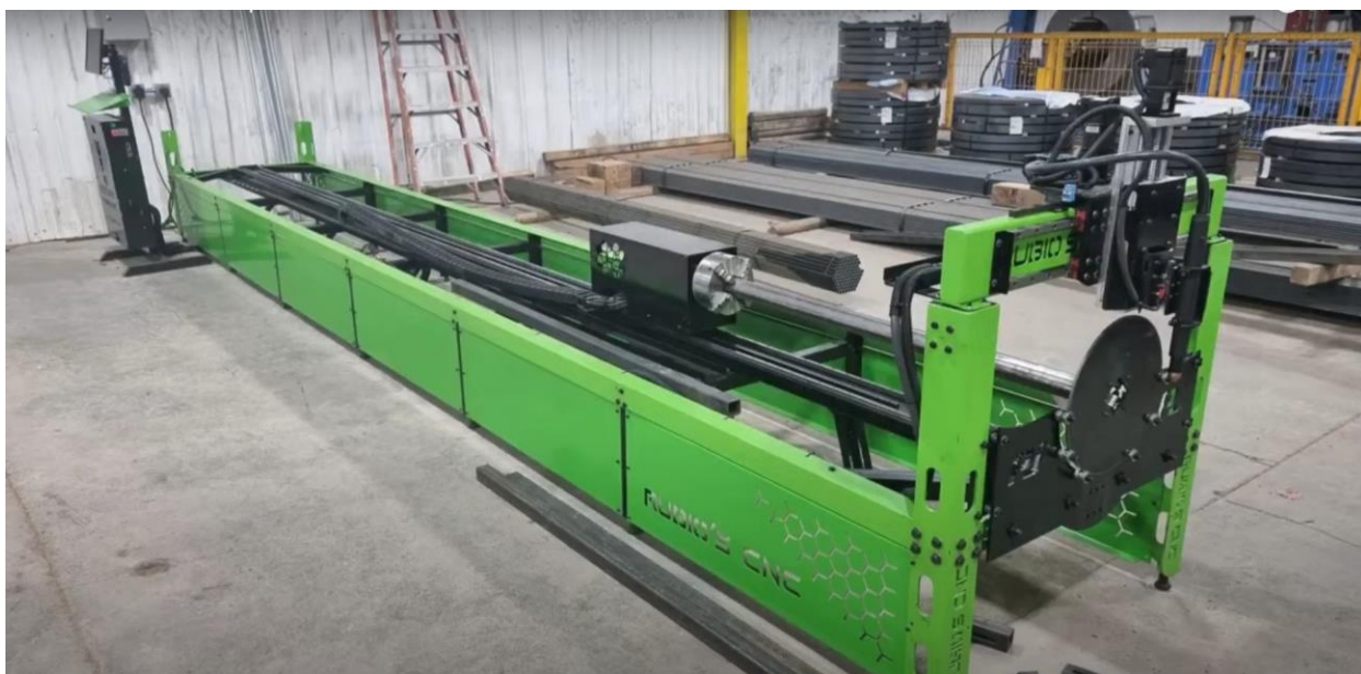
Рисунок 2.3 – Верстат плазмового різання профільного прокату RUBIOS CNC Rotary D4
