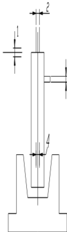
Таблиця 3.3 - Схема операційного контролю установлення колон
