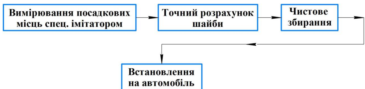
Рисунок 1.3 – Сучасний метод ремонту редуктора головної передачі (інструментальний)
