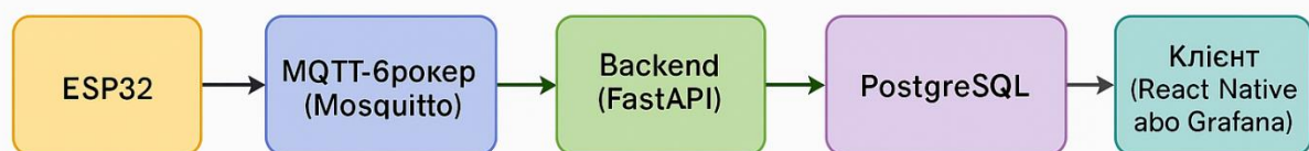
Рисунок 2.5 - Логіка передачі даних через MQTT
