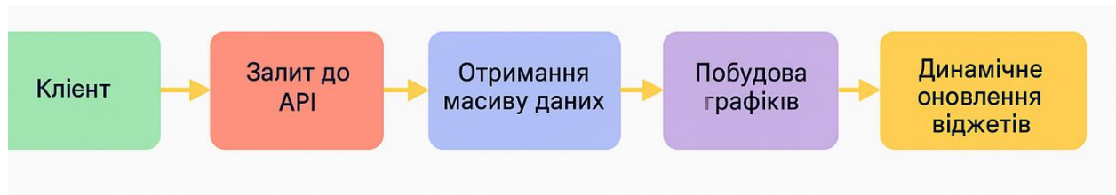
Рисунок 2.6 - Логіка роботи інтерфейсу користувача
