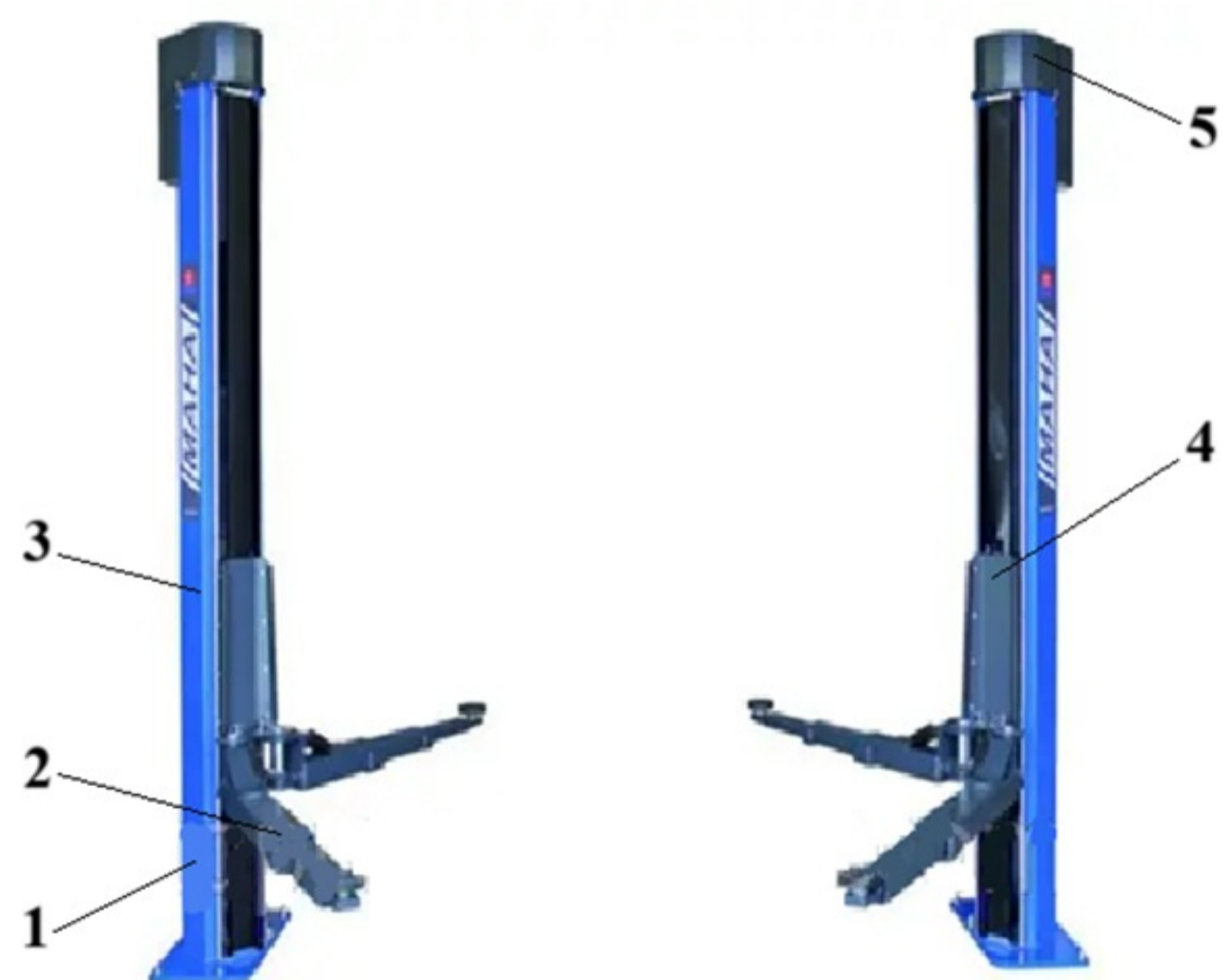
1 – стійка; 2 – розсувні підйомні важелі; 3 – гвинт; 4 – гайка; 5 – електродвигун
