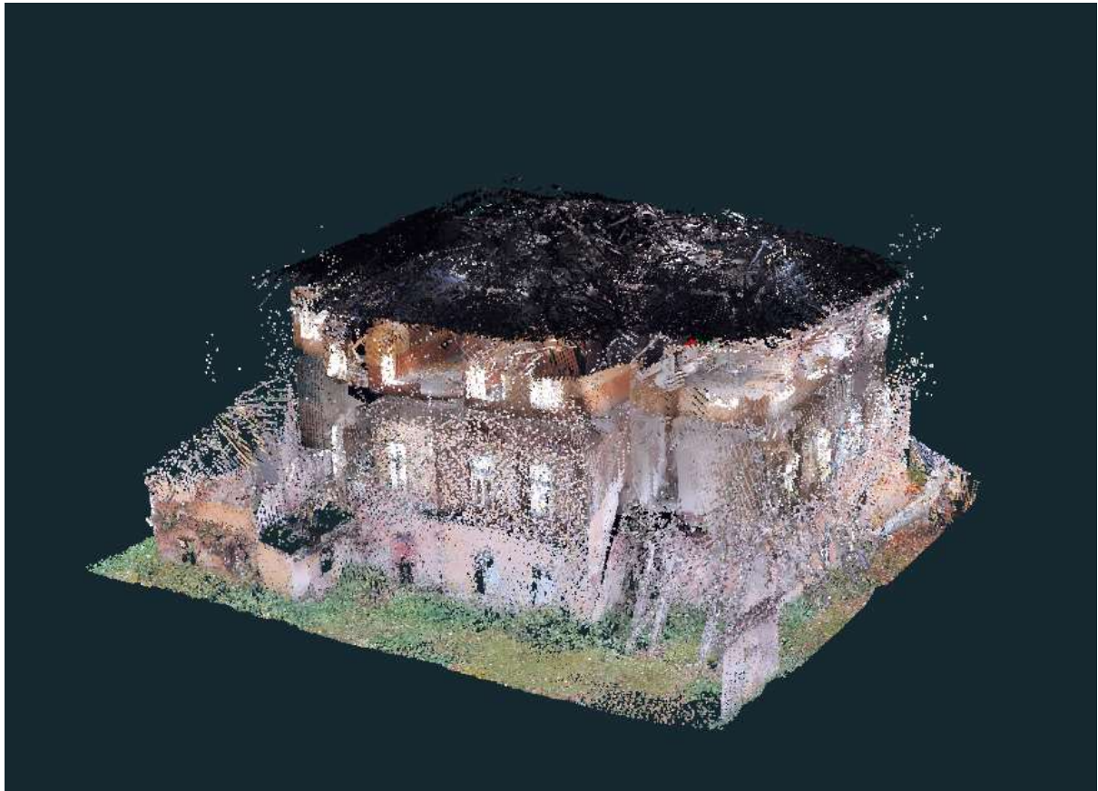
Рис. 9. Отримана лазерно-сканована 3D-модель
