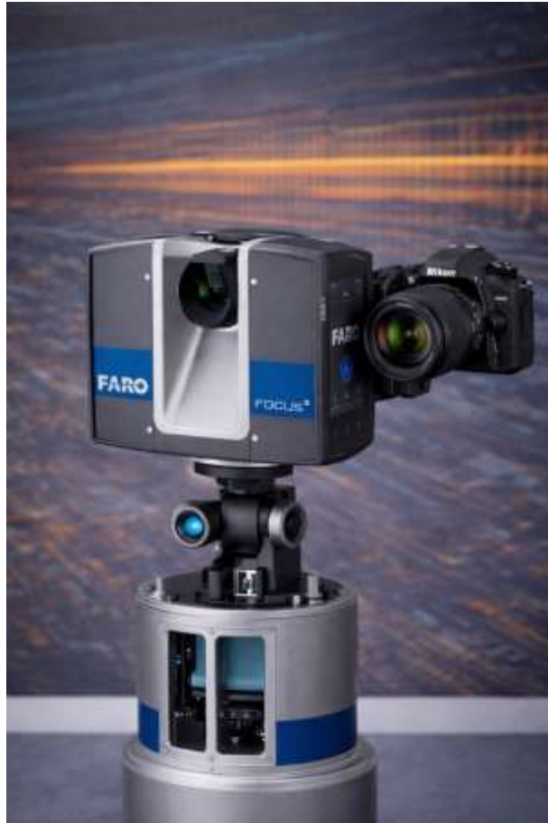
Рисунок 1. Камера Nikon D100, жорстко закріплена на системі FARO
