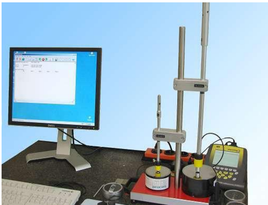
Рисунок 2.13 – Первинний еталон шкал твердості Ліба у Physikalisch-Technische Bundesanstalt (РТВ), Німеччина
