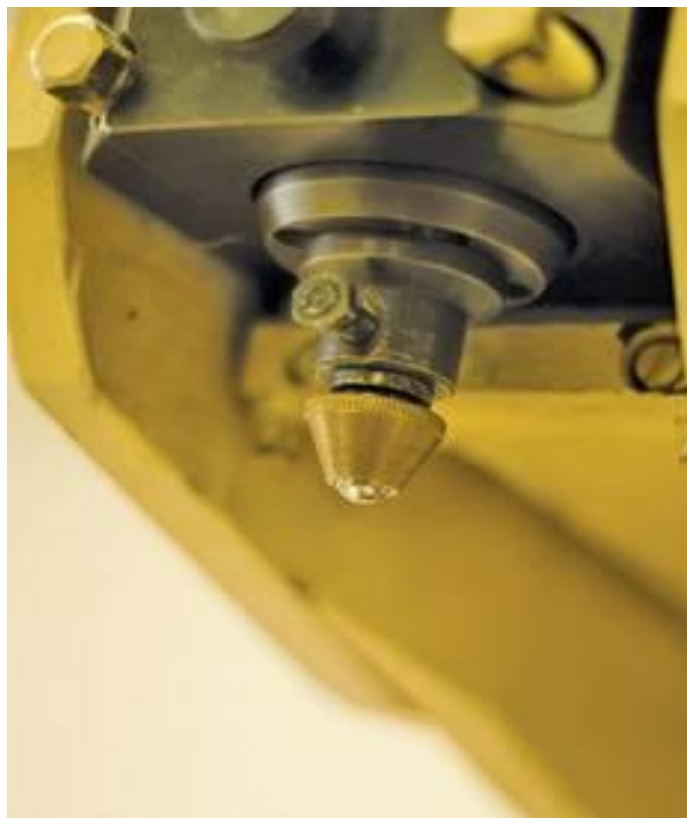
Рисунок 2.11- Державна первинний еталон для засобів вимірювань твердості за шкалами Роквелла і Супер-Роквелла
