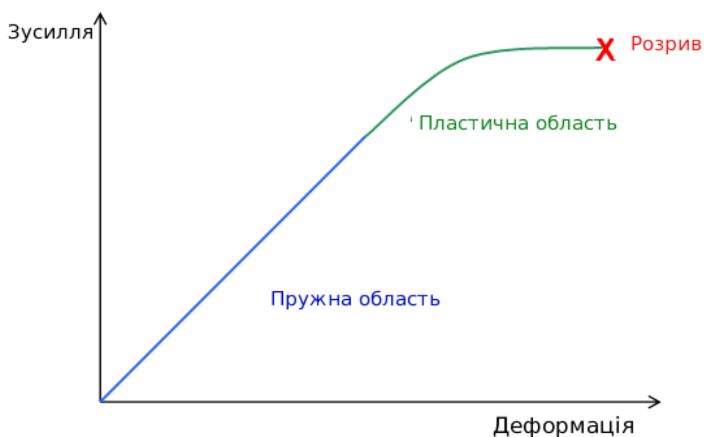
Рисунок 1.1 – Типова крива залежності деформації розтягу від напруження.
