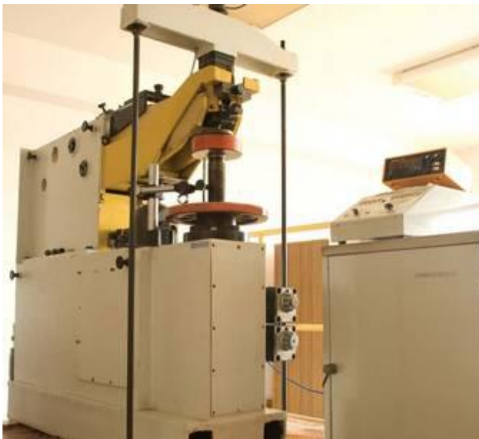
Рисунок 2.10 - Державна первинний еталон для засобів вимірювань твердості за шкалами Брінелля та Віккерса
