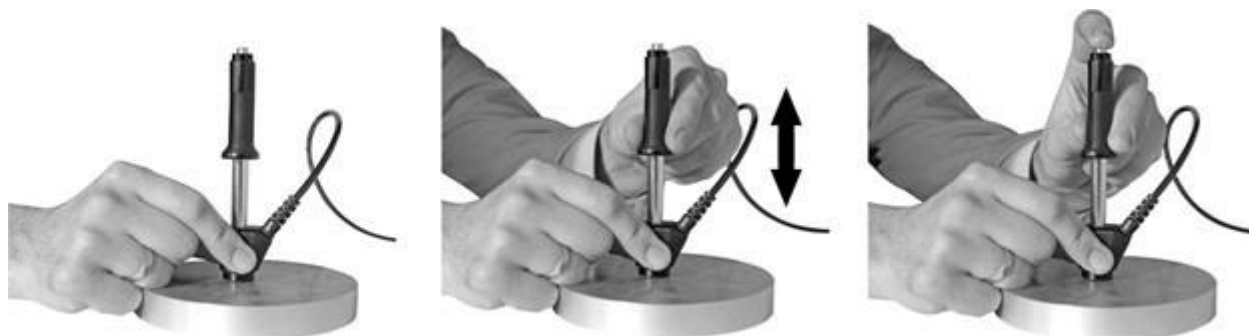
Рисунок 2.4 – Проведення вимірювань твердоміром методом Ліба
