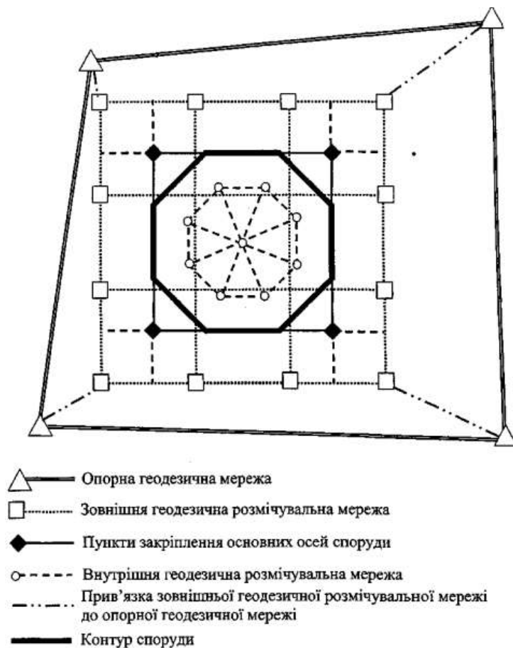
Рисунок 3.2 – Традиційна схема опорної зовнішньої та внутрішньої розмічувальних геодезичних мереж згідно ДБН ( без використання ГНСС)
