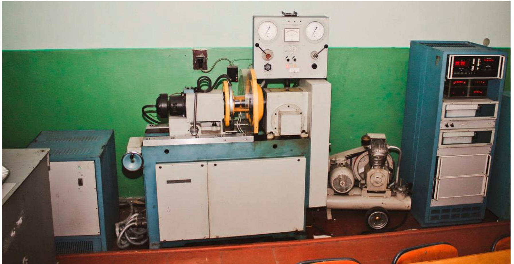
Рисунок 7 – Загальний вигляд машини тертя 2168 УМТ: 1 – силовий агрегат; 2 – машина тертя; 3 – панель керування
