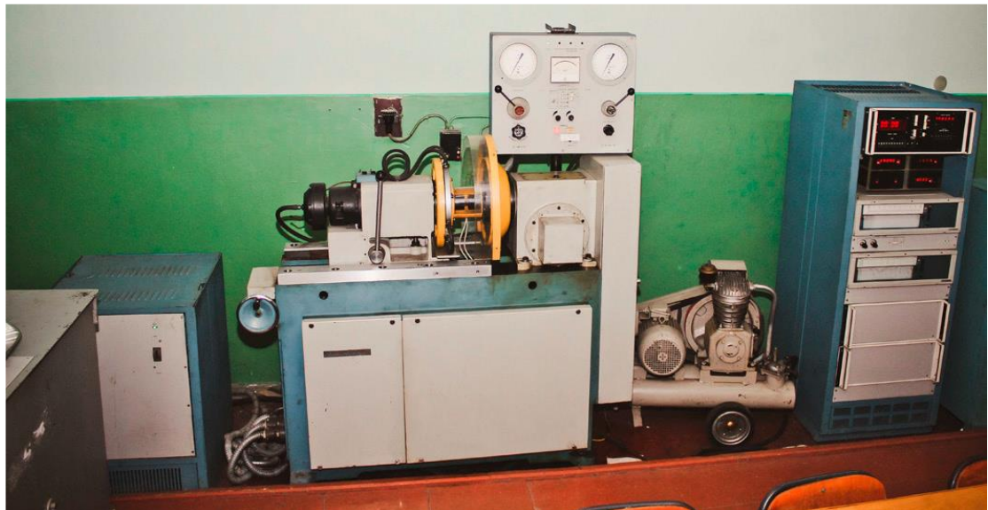
Рисунок 3.3 – Загальний вигляд машини тертя 2168 УМТ: 1 – силовий агрегат; 2 – машина тертя; 3 – панель керування
