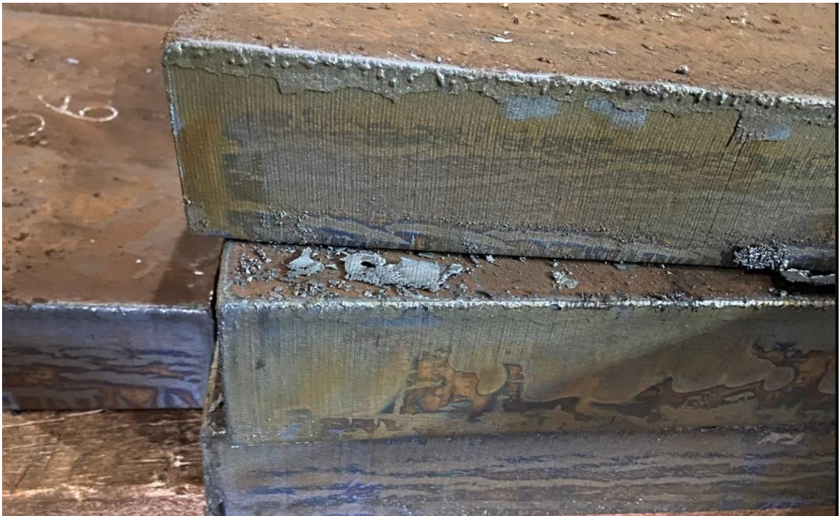
Рис. 1.2 – Кромка після плазмового різання без дефектів
