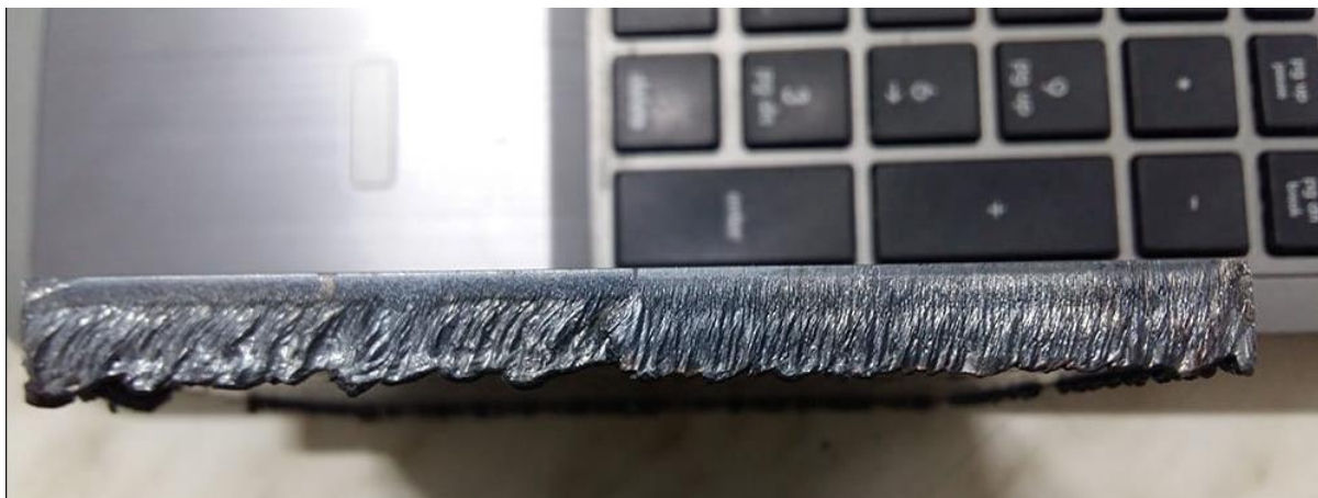
Рис. 1.3 – Кромка після плазмового різання з дефектами
