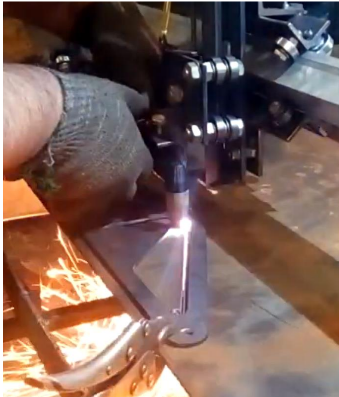
Рис. 1.4 – Приклад механізованого різання плазмою по шаблону
