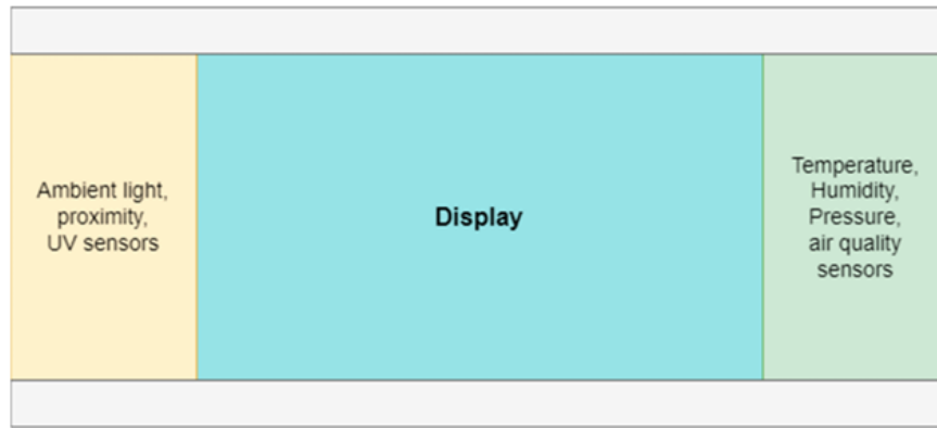
Рисунок 3.6 - Розташування дисплея та блоку датчиків
