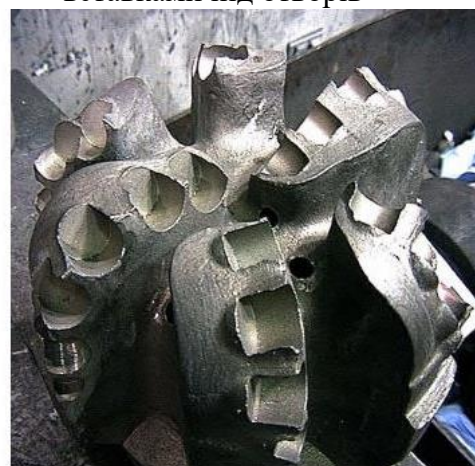
Рисунок 1.9 - Спечена заготовка долота
