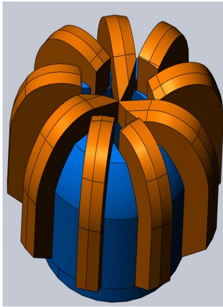
Рисунок 3.5 – 3Д-модель корпусу долота із встановленими лопатями в пази
