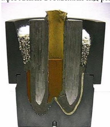
Рисунок 1.8 - Встановлення коронкового кільця в графітовій формі для спікання
