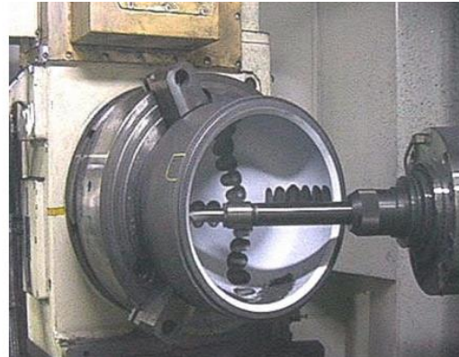
Рисунок 1.5 - Фрезерування отворів під різці
