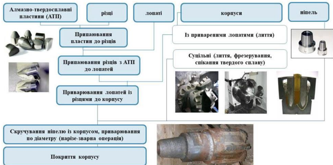
Рисунок 2.1 – Технологія виготовлення доліт ріжуче-стираючої дії
